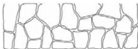
Obr. 11. Dlažba z nepravidelného ostrohranného kamene, skladba „na divoko“.
