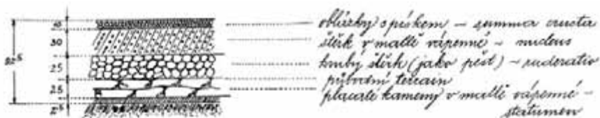
Obr. 1. Konstrukce starořímské silnice dle literatury z roku 1911.
